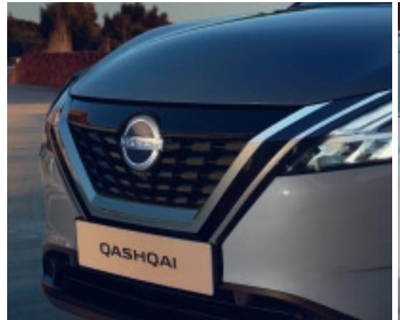
Фірмова решітка радіатора V-Motion
